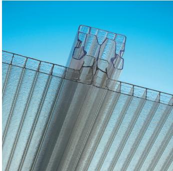
Un sistema versatile in policarbonato alveolare che può essere utilizzato in molte applicazioni grazie alla sua modularità e resistenza. È ideale per tamponamenti verticali, finestre, tetti piani e curvilinei, anche di grandi dimensioni. L'estruzione della piastra permette un perfetto aggancio a scatto su montanti con incastri aperti, creando così un eccezionale gruppo autoportante e assoluta planarità della superficie.
