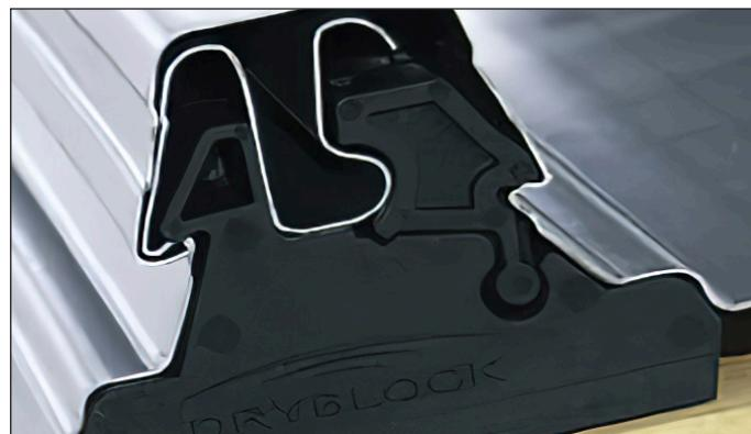
Particolarità esclusiva del sistema Drytec® è l'aggancio in sormonto. Continuo per tutta la lunghezza della greca, aumenta le caratteristiche meccaniche del profilo (portata e tenuta all'acqua). Per l'applicazione degli accessori (fotovoltaico, fermaneve, linee vita) si prevede l'utilizzo della staffa Multiblock che consente, senza fori, l'installazione dei componenti aggiuntivi.
