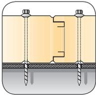
La perfetta configurazione del giunto rende piacevole e uniforme la superficie dell'involucro edilizio, e consente al pannello di abbattere considerevolmente i ponti termici che, come è noto, sono causa di dispersione energetica e formazione di condensa.
