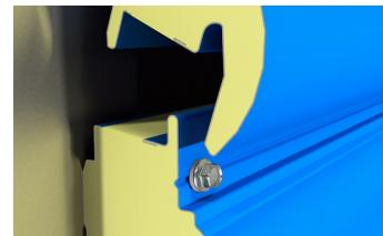
La perfetta configurazione del giunto rende piacevole e uniforme la superficie dell'involucro edilizio, e consente al pannello di abbattere considerevolmente i ponti termici che, come è noto, sono causa di dispersione energetica e formazione di condensa.
